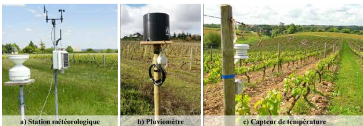
Figure 2 : a, b) Station météorologique et pluviomètre installés à proximité des vignes et c) capteur de température installé au sein de la parcelle, sur un piquet en bois.
